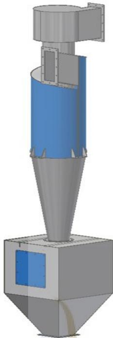
**Рис.1 Циклон типа ЦН-15**
